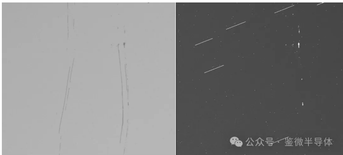
图 4：深层划痕（左图竖线）特征：光致发光通道可见（左图）表面形貌通道不可见（右图）
